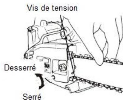
8. Serrez les écrous et vérifiez si la chaîne à une rotation correcte et elle est bien tendue.
