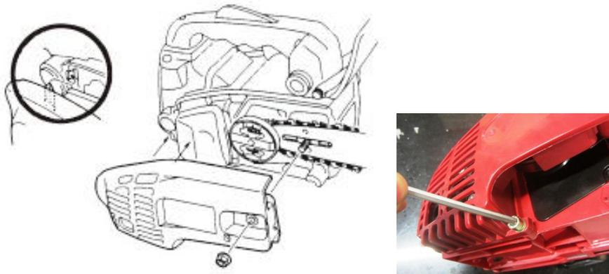
7. Réglez la tension de chaîne en tournant la vis de tension jusqu'à ce que les courroies d'attache touchent juste le côté bas de la barre.
