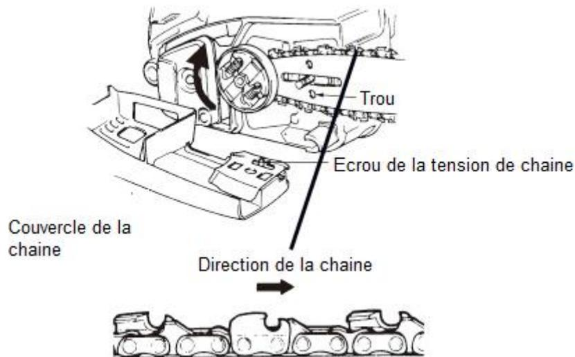
6. Ajustez l'écrou de mise sous tension de la chaîne dans le trou inférieur du guide. Installez ensuite le carter de la chaîne et fixez l'écrou de montage et enfin vissez la vis hexagonale.
