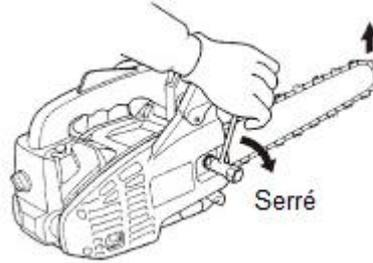
Tout en soulevant le guide chaîne, tournez le vis du teneur pour appliquer une tension correcte à la chaîne. Ensuite bloquez les écrous du carter.
