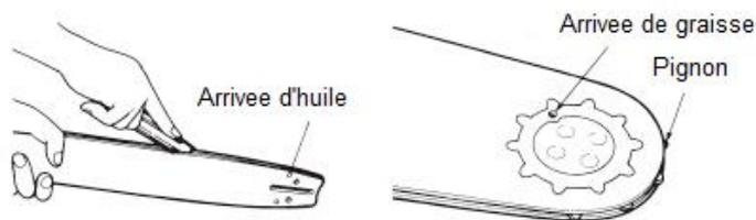
Vérification: Inversez la barre de temps en temps pour éviter les effets de l'usure. Le rail du bar devra toujours être en place. Utilisez une règle pour l'observer. Si un écart est observé entre eux, le rail est donc normal. Dans le cas contraire, cela veut dire que le rail est usé. Une barre devra être corrigé ou remplacé.
